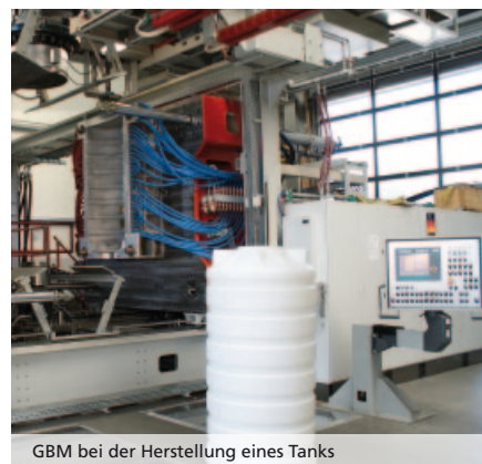
GBM bei der Herstellung eines Tanks
